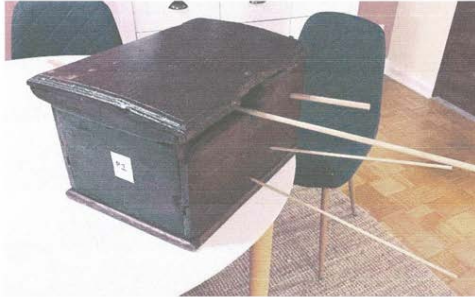
Foto 6: Seitliche Darstellung zeigt die den Weg und den Winkel der Geschöße. Vermutlich wurde auf die Kiste von vorne in einem flachen Winkel geschossen.
